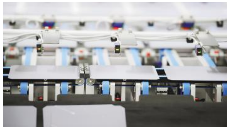
通威太阳能智能制造生产线,刻蚀下料自动化
