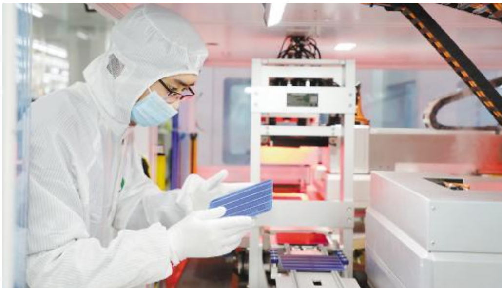
周元武确认印刷品质,是否漏浆、断栅及虚印
