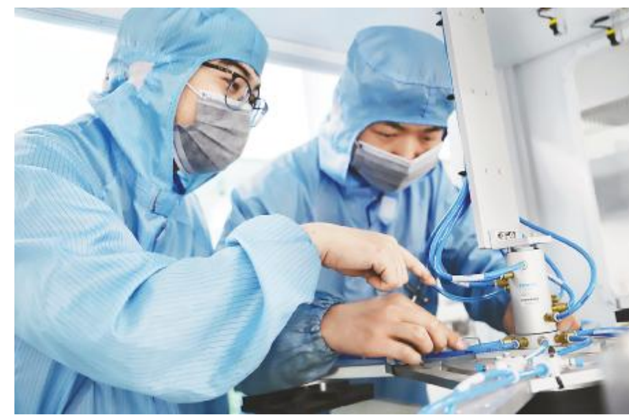
设备部更换正背检漏环
